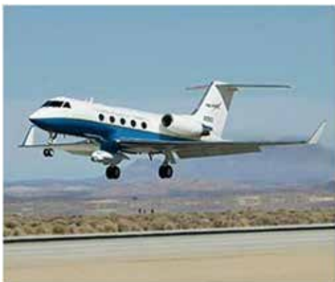
雷达勘测任务之前，腹部悬挂UAVSAR的NASA C-20A地球科学研究飞机在爱德华兹空军基地跑道上起飞。
