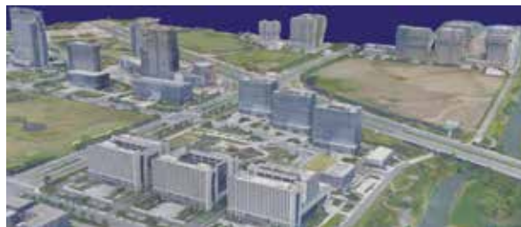
基于无人机倾斜摄影的苏州高新园区三维建模
